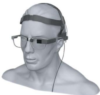
**Неинвазивный интерфейс «мозг-компьютер»** (ИМК или BCI от англ. brain-computer interface) современная технология коммуникации пользователя с электронными и электронно-механическими устройствами, основанная на непосредственном преобразовании намерений пользователя, отраженных в регистрируемых пространственно-временных электрических сигналах мозга, в управляющие команды.
