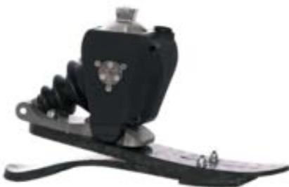
**КИМ-20** – бионический коленный модуль, сочетающий в себе естественность движений с одной стороны, а с другой стороны невысокую массу и цену. В основе коленного модуля лежит надежное, проверенное временем решение на основе управляемой гидравлики. Интегрированная система управления обеспечивает пользователю защиту от неконтролируемого сгибания в любых условиях. Модуль КИМ-20 может длительное
