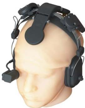
**«Окулографический интерфейс»** – комплекс аппаратно-программных средств, физический принцип действия которого основан на бесконтактной регистрации движения глаз. Отслеживая движение глаз, комплекс определяет, на каких объектах сфокусировано внимание пользователя и, анализируя паттерны этих движений, определяет намерение пользователя по выполнению действия с этими объектами. В настоящее время в рамках ФЦП «Развитие фармацевтической и медицинской промышленности
