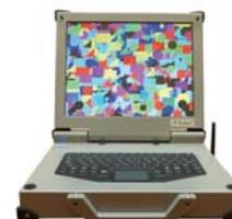
Защищённые ноутбуки НТ-Эльбрус и НТ-R1000-высокопроизводительные носимые терминалы (далее НТ), выполненные в ударопрочном защищенном влагостойком корпусе. Они предназначены для работы в качестве автоматизированного рабочего места оператора в жестких условиях эксплуатации.
