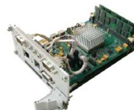
**Вычислительные модули МВК/У и МПУЗ/С** выполнены на базе микропроцессора Эльбрус-2С+ (1891ВМ7Я) и МЦСТ R1000 (1891ВМ6Я) с пиковой производительностью 28 и 16 Gflops на одинарной точности при тактовых частотах 500МГц и 1000 МГц соответственно. Модули предназначены для организации компактных, стационарных или перебазируемых вычислительных систем для работы в вычислительных системах с повышенными требованиями к информационной безопасности и отказоустойчивости.
