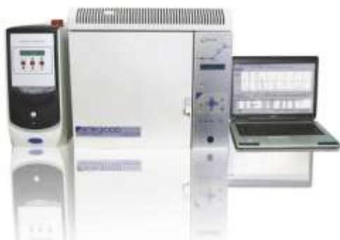
Хроматограф ЛГХ-3000 применяется для определения состава многокомпонентных смесей в газонефтеперерабатывающей, химической, парфюмерно-косметической и пищевой промышленности, в лабораториях контроля качества продукции и охраны окружающей среды, сертифицировано как медицинское оборудование. В настоящее время в Обществе организовано единичное производство.
