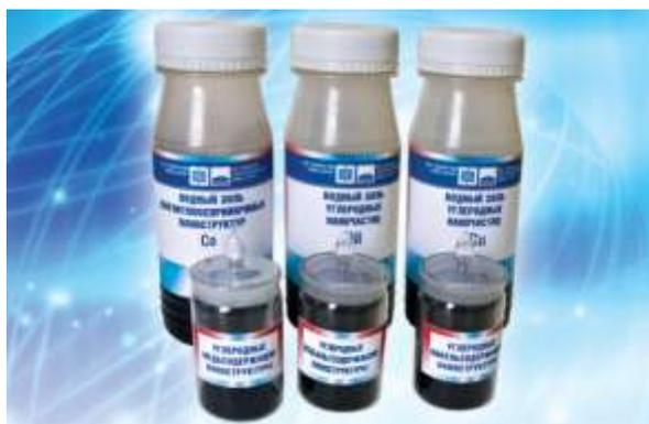
Основное назначение наноструктур - модифицирование различных материалов для значительного улучшения их свойств с минимальными затратами. В лаборатории отработаны технологии получения около 20-ти типов металлсодержащих наноструктур в углеродных оболочках (на основе меди, железа, никеля, кобальта).
