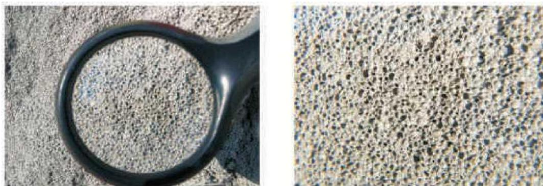
Такой подход к получению ячеистого бетона стал возможен при применении **НАНО-ТЕХНОЛОГИЙ**: сухая смесь газозифробетона, содержащая многослойные углеродные нанотрубки, относится к промышленным строительным материалам, а именно к составам для производства неавтоклавного ячеистого бетона. При введении в такую смесь углеродных многослойных нанотрубок упорядочивается структурообразование строительных изделий, что приводит, в свою очередь, к улучшению их свойств.
