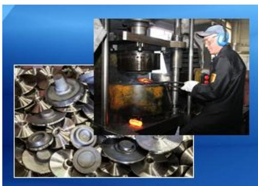
На рынке автомобильных запчастей России ОАО «ИЭМЗ «Купол» с 2000 года – изготавливает **детали торцевой раскатки** (поковки повышенной точности из черных и цветных металлов методом полугорячей штамповки). Производство поковок методом торцевой раскатки является востребованным и перспективным направлением деятельности предприятия: рынок насыщен предложениями от производителей поковок различных типоразмеров, в том числе и изготовление дисков сцепления для легковых и грузовых автомобилей.
