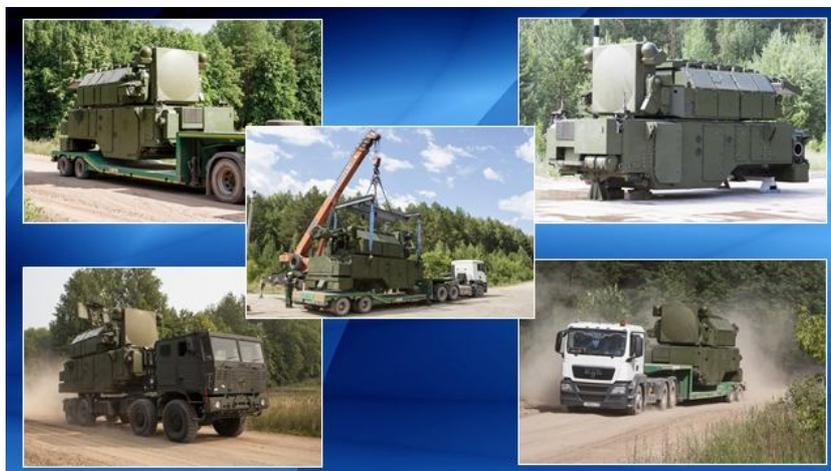
Боевые и технические средства данного изделия возможно размещать на автомобильных шасси, прицепах, полуприцепах и платформах соответствующей грузоподъемности, а так же в стационарном варианте.
